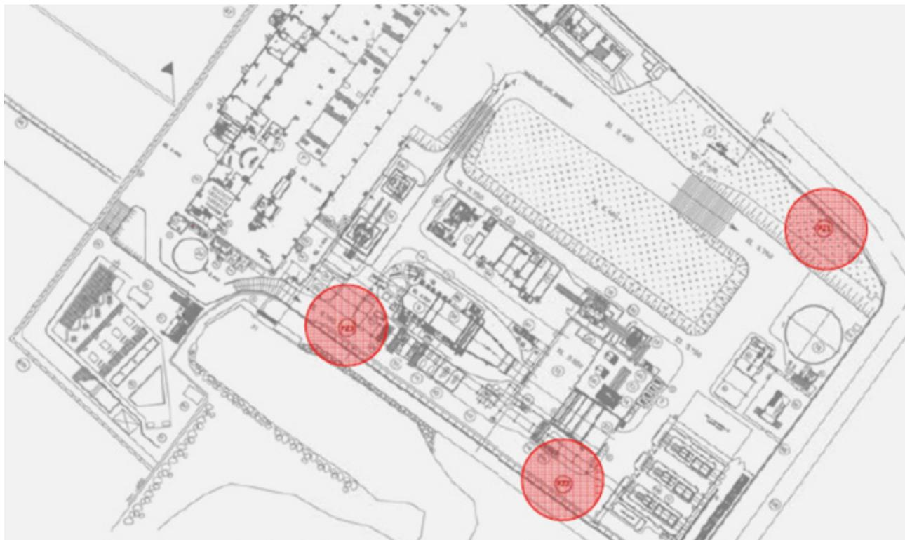
Figura n. 15: Localizzazione dei piezometri di monitoraggio falda
