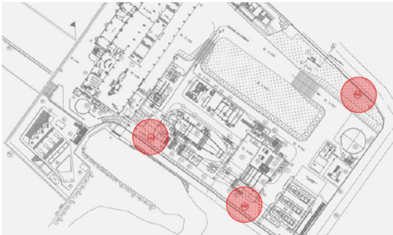
Figura 15: Localizzazione dei piezometri di monitoraggio falda
