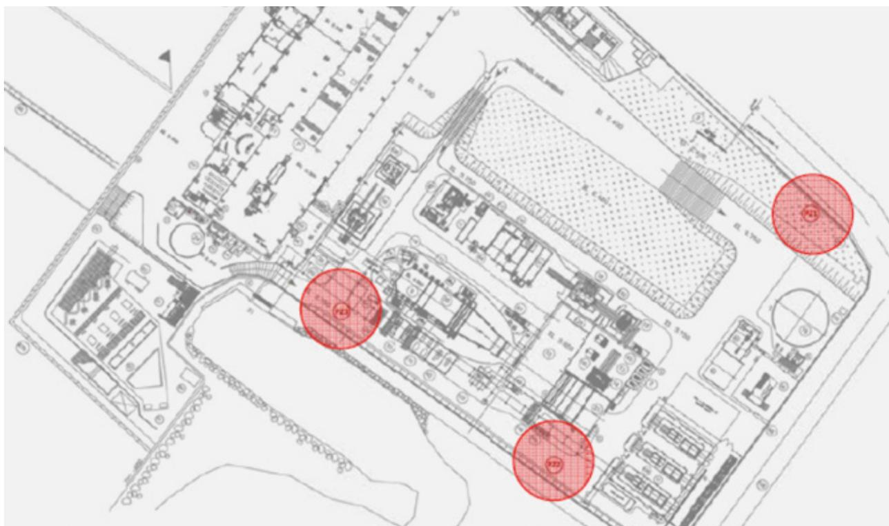
Figura 16: Localizzazione dei piezometri di monitoraggio falda
